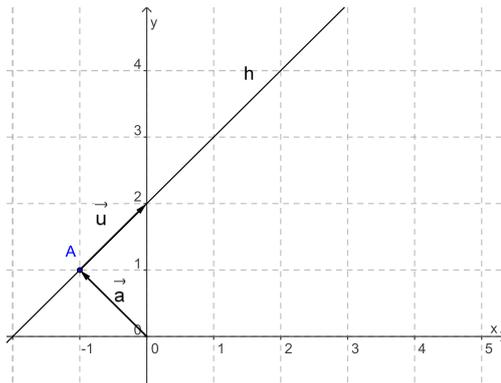
Der Aufpunktvektor  $\vec{a}$  ist der Ortsvektor eines Punktes der Geraden  $h$ . Der Richtungsvektor  $\vec{u}$  zeigt bei beliebiger Länge in Richtung der Geraden.
